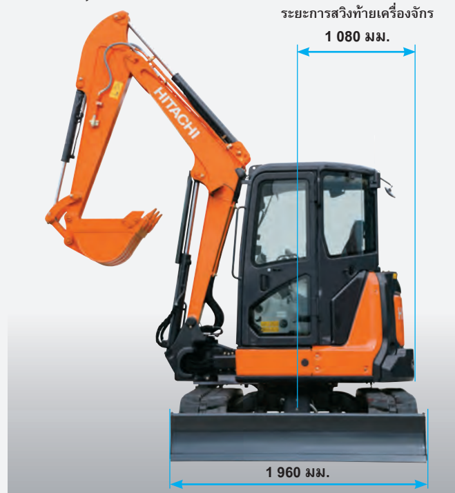
อุปกรณ์ในภาพติดตั้งอาร์มขนาด 1.69 เมตร ระบบท่อเสริม และเคาน์เตอร์เวทแบบเสริมน้ำหนัก
